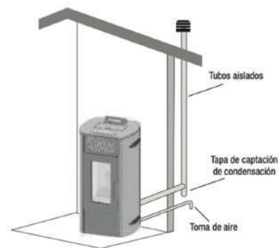
Imagen 4: instalación de combustión externa
