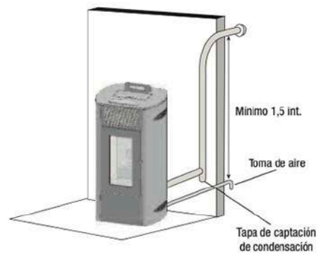
Imagen 3: Instalación de salida de humos interna que se deberá realizar de conformidad con las normas.
