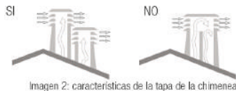
Imagen 2: características de la tapa de la chimenea
