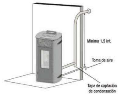
Imagen 3: instalación de salida de humos interna que se deberá realizar de conformidad con las normas.
